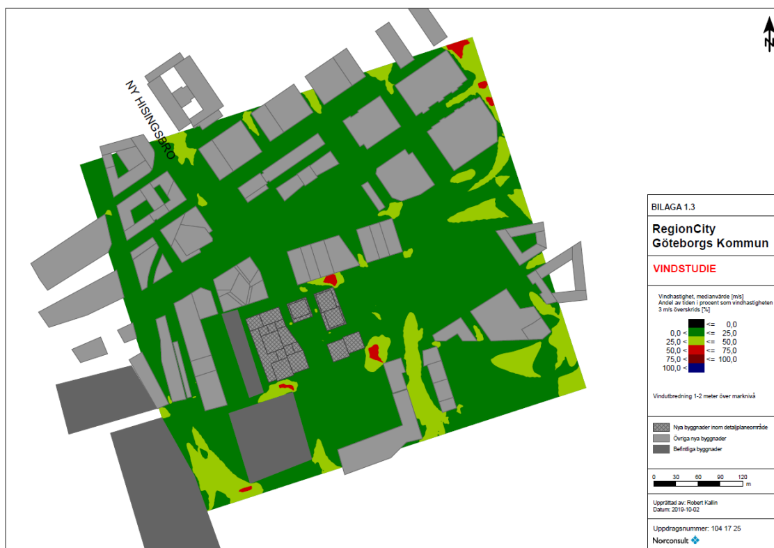
Figur 5.3. Medianen av vindhastighet över 3 m/s. Medianen (50 %) överskrids inte i de gröna områdena som är lämpliga för kortvarig vistelse.
